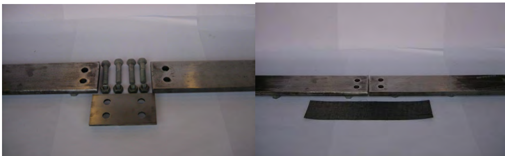
Figur 4.4 Ingående delar i provkropp referens bultar och referens kolfiber
