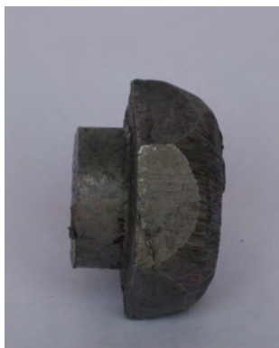
Figur 4.3 Avrundad och kapad bultskalle.
