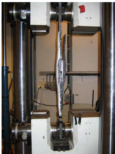
Figur 5.7 Brott på provkroppen "kolfiber och bultar"
