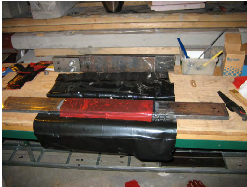
Kolfiberkompositen på provkroppen "referens kolfiber" härdar
