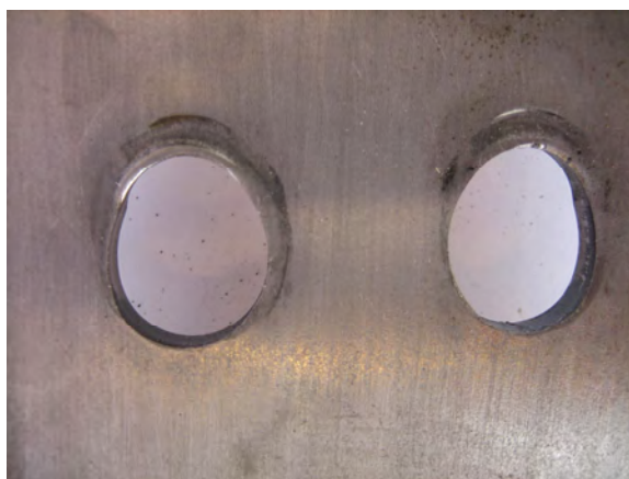
Figur 5.3 Hålkantsbrott på förbandsplatta
